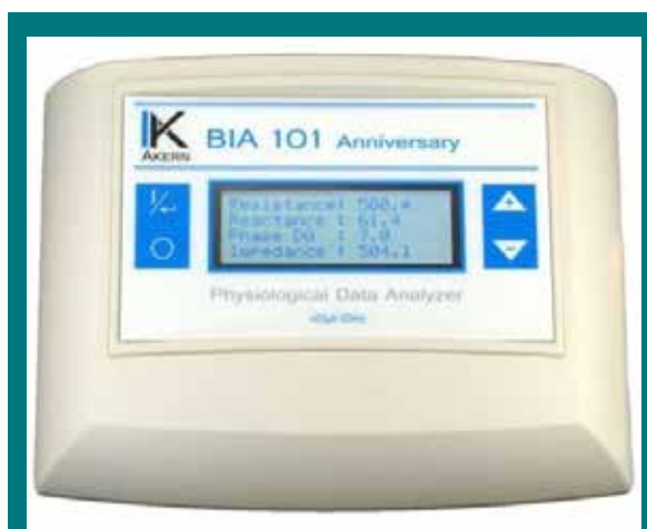
Figura 3. Dispositivo de bioimpedancia eléctrica que muestra los parámetros medidos durante la exploración: resistencia, reactancia, ángulo de fase e impedancia
